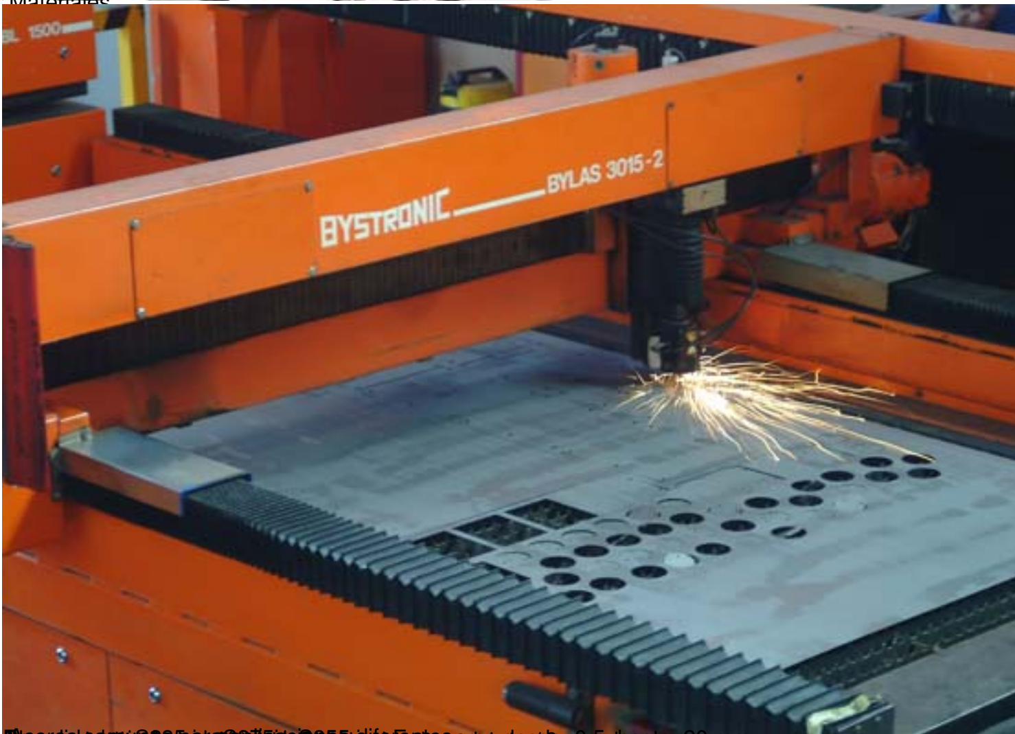
Aluminio 6065 de 3 mm y 6 mm, acero inoxidable 304 de espesor 1,5 mm y 3 mm, cobre de espesor 1,5 mm, aluminio 6065 de espesor 1,5 mm y 3 mm, aluminio 6065 de espesor 1,5 mm y 3 mm
