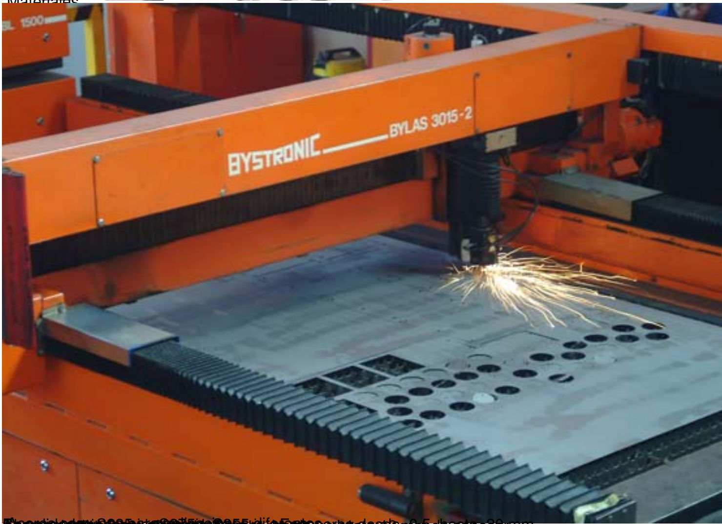
Aluminio 6065 de espesor 3mm y 5mm, acero inoxidable de espesor 1,5 y 2mm y de espesor 3mm
